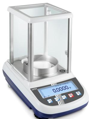
Sistema automático de ajuste - cambio de temperatura estándar 1,2 °C
